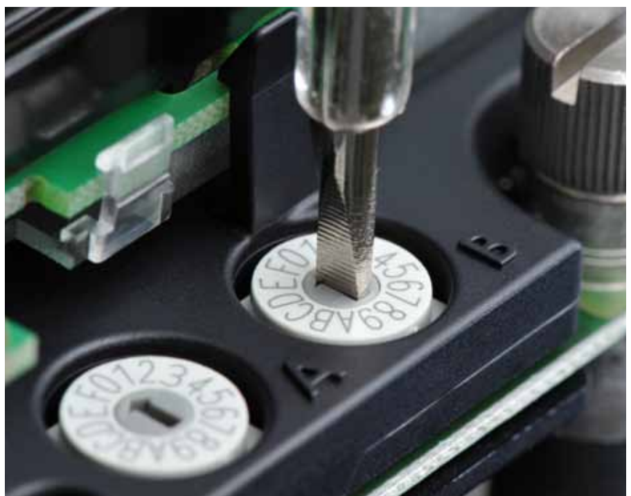
De specifieke configuratie voor elk land in een handomdraai: draaischakelaars aan de Sunny Boy 5000TL
